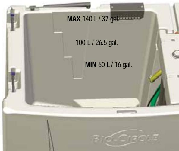
4. Para obtener un óptimo rendimiento, siempre mantenga el nivel de líquido al menos en 100 litros/21 gal., no llenar por encima del nivel máximo. No permita que el nivel de solución quede por debajo de los 60 litros. Observe las líneas marcas en la pared del tanque.
