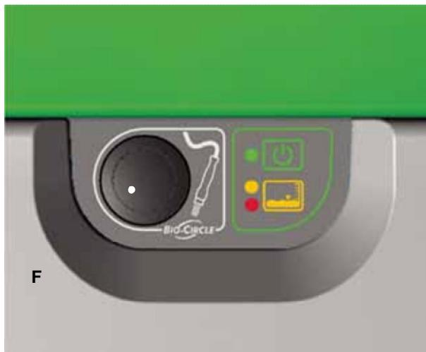
5. O processo de bioremediação requer um ambiente favorável por todo o tempo, até mesmo quando o equipamento não estiver em uso. **Mantenha sempre o nível da solução próximo ao máximo e a máquina ligada** a fim de manter a temperatura adequada e a provisão de oxigênio através da aeração.
